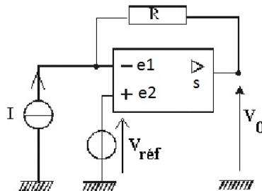
L'amplificateur opérationnel (AO) est supposé parfait et fonctionne en régime linéaire. Admettons que dans ce régime  $v_{e1} = v_{e2}$  - le potentiel à l'entrée 1 est égal au potentiel à l'entrée 2, et  $i_{e1} = i_{e2} = i_s = 0$ , les courants entrants et sortants de l'AO sont nuls. Sur le schéma on voit une source de courant et une source de tension.
