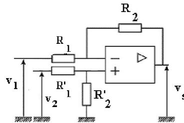
8. Exprimer la tension de sortie  $v_s$  en fonction de  $v_1$  et de  $v_2$  ainsi que des différentes résistances. Le montage est présenté sur la figure en dessus.
