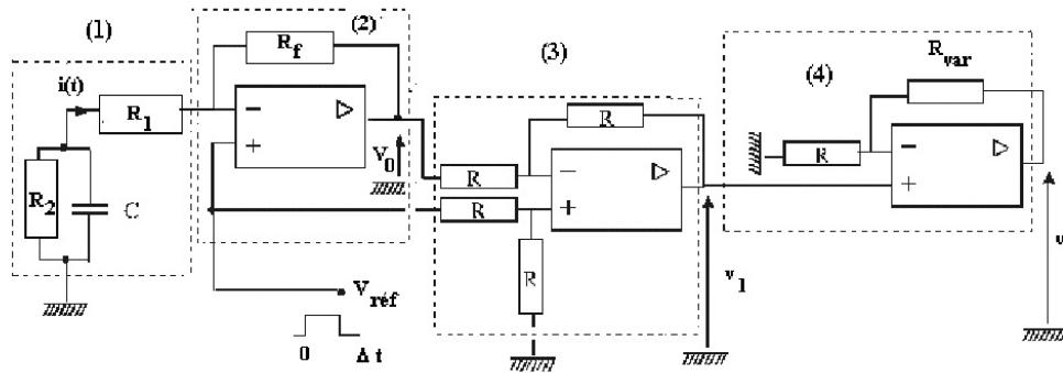
On modélise par  $R_1$  la résistance équivalente de la pipette précédente,  $R_2$  et  $C$  représentent la résistance et la capacité de la membrane (bloc 1) :
