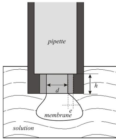
20. Exprimer la résistance de jonction  $R_{seal}$  en fonction de  $h$ ,  $d$ ,  $e$  et  $\sigma$ . Calculer numériquement  $R_{seal}$ .
