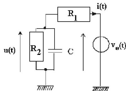
Nous considerons le circuit ci-contre constitué d'un condensateur de capacité  $C$ , initialement déchargé, de deux résistances  $R_1$  et  $R_2$ , alimenté par un générateur délivrant un signal variable dans le temps  $v_e(t)$ . Nous allons appliquer à ce circuit une stimulation d'amplitude  $\Delta V = V_{ref} > 0$  et de durée  $\Delta t$ , c'est-à-dire  $v_e(t)$  va varier dans le temps suivant cette loi.
